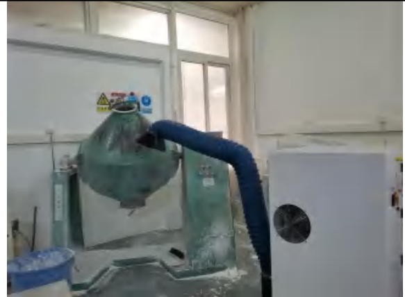
铝酸盐混料间（集气罩+滤筒除尘器）
