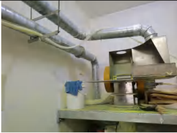
铝酸盐、硅酸盐出粉块—集气罩和滤筒除尘器（厂区东侧）
