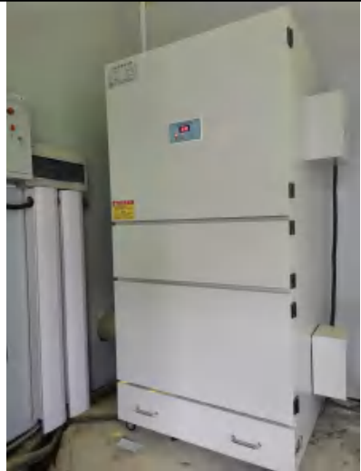
铝酸盐、硅酸盐出粉块—集气罩和滤筒除尘器（厂区东侧）
