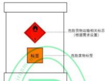
图1 危险废物标签设置示意图
